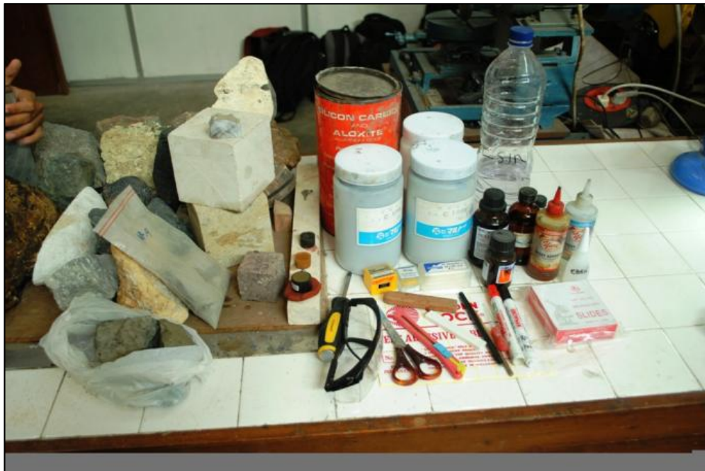
Gambar 1.1.6 Beberapa alat dan bahan yang digunakan dalam pembuatan sayatan tipis batuan
