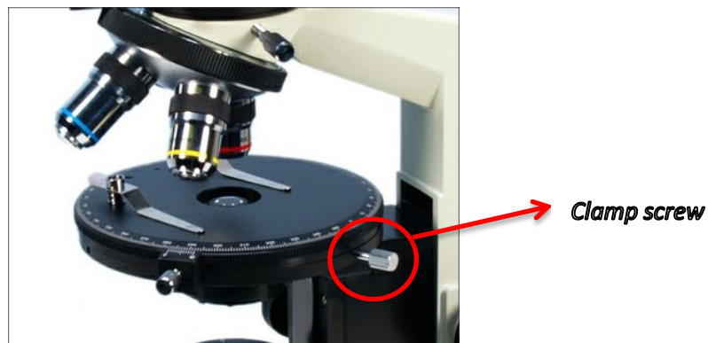
Gambar 1.1.4 Ilustrasi proses centering
