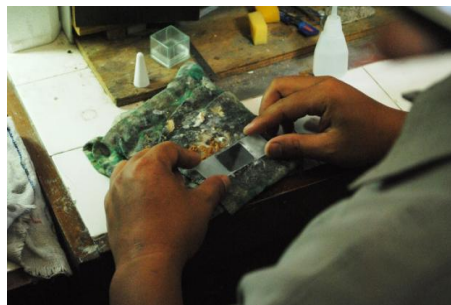
Gambar 1.9 Proses penempelan sampel
