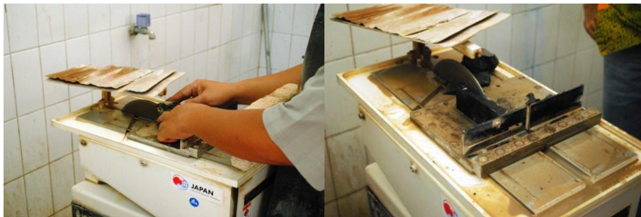
Gambar 1.1.7 Mesin pemotong dan proses pemotongan sampel batuan
