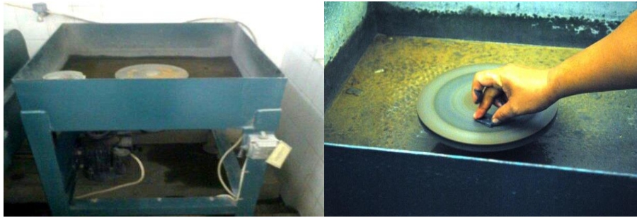
Gambar 1.1.8 Mesin gerinda dan proses penghalusan sampel
