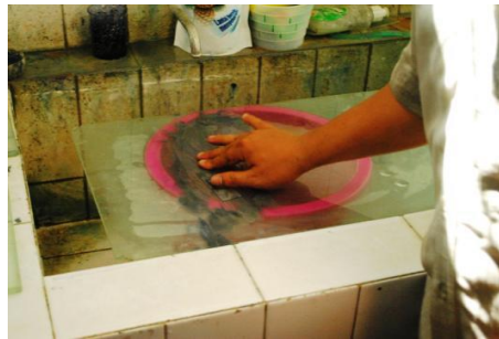
Gambar 1.10 Proses penipisan sampel secara manual
