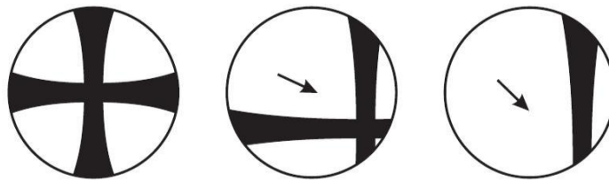
Gambar 4.5 Bentuk isogir mineral uniaxial
